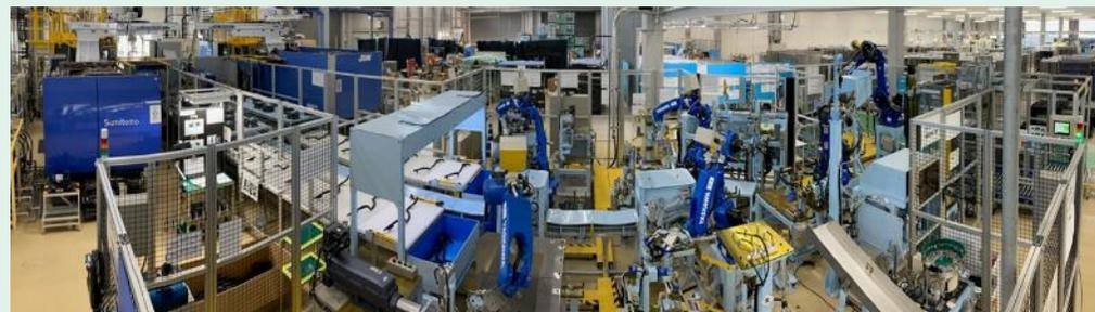
材料投入から成形、組立、検査、完成品の出荷までを完全自動化
